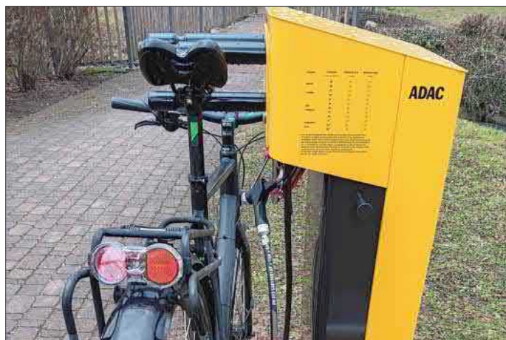
Die Reparatursäule ist mit hochwertigem Werkzeug ausgestattet und verfügt auch über eine Radaufhängung zur leichteren Nutzung bei Fahrrad Reparaturen.
